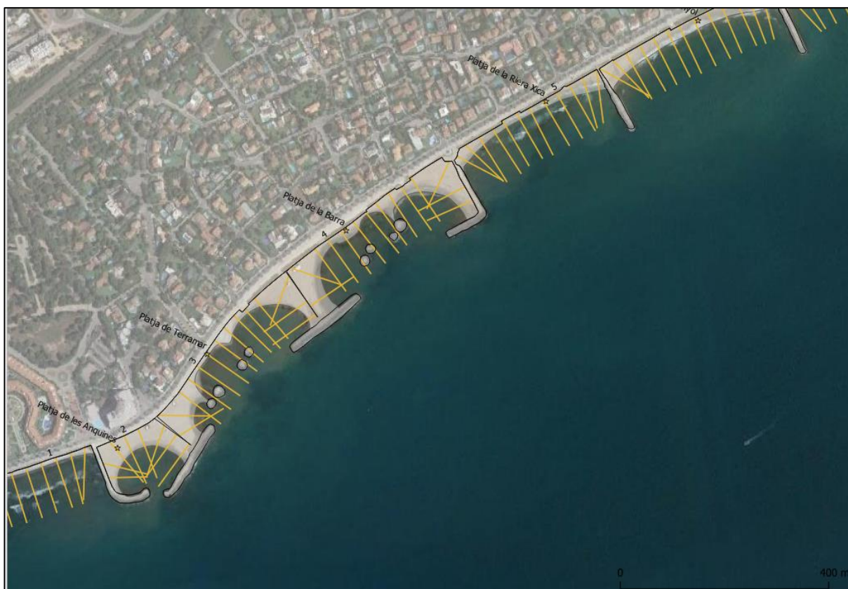
Figura 27 Exemple de transsectes ortogonals a la línia de costa, separats cada 30m (en groc).
