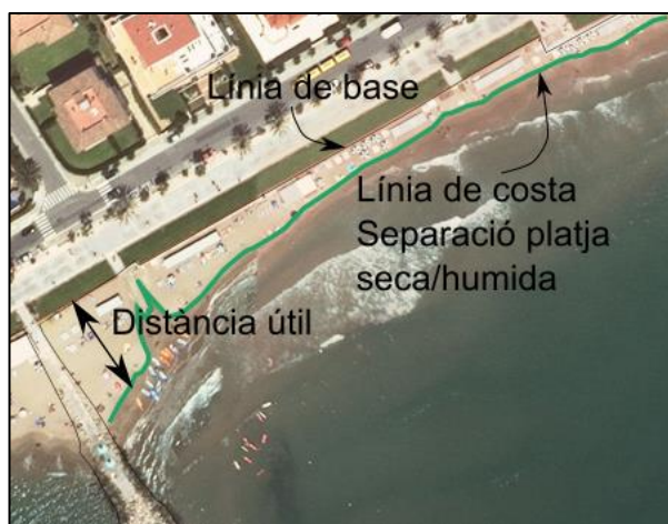
Figura 26 Exemple de digitalització de la línia de costa mitjançant la separació de la platja seca/humida i la resultant distància útil de platja.
